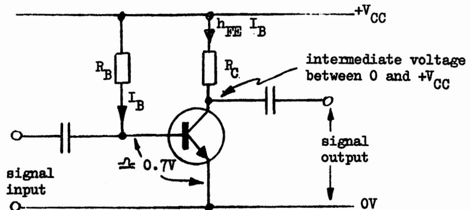
Fig. 1 : A simple transistor amplifier
