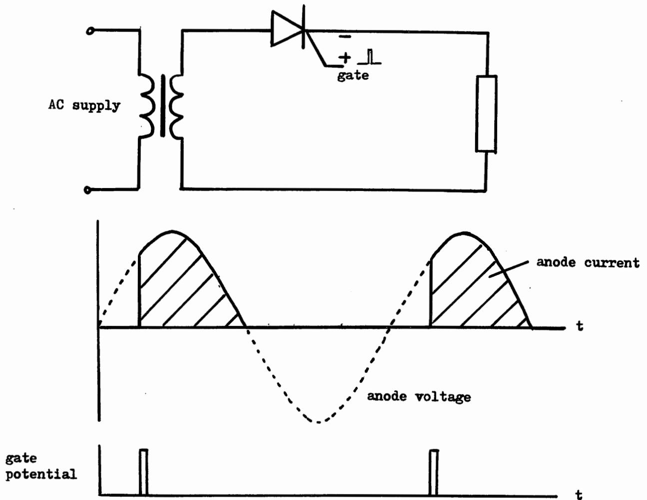
Figure 10 Thyristor Diode Rectifier
