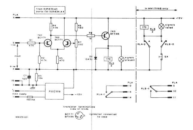
Fig. 1. Circuit Diagram of the MN2/516A and MN2/516B
